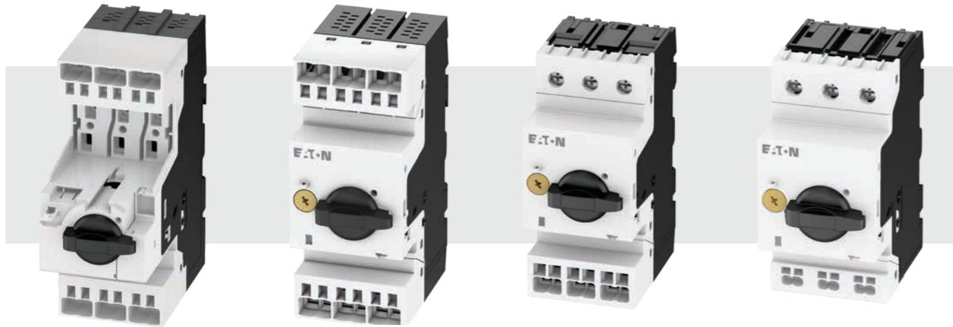
De Eaton motorbeveiligingsschakelaars zonder smeltzekering combineren kortsluit- en overbelastingsbeveiliging in één apparaat. Dankzij de geïntegreerde elektronische beveiliging met groot bereik bestrijkt de PKE met slechts 4 typen het stroombereik van 0,3 tot 32 A, wat voorraad bespaart en projectplanning vereenvoudigt. De 13 modellen van de elektromechanische PKZM0 bestrijken het stroombereik van 0,1 tot 32 A.
